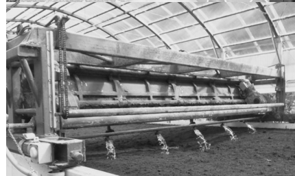
堆肥発酵槽（大川村） 攪拌機から生物活性水を散水
